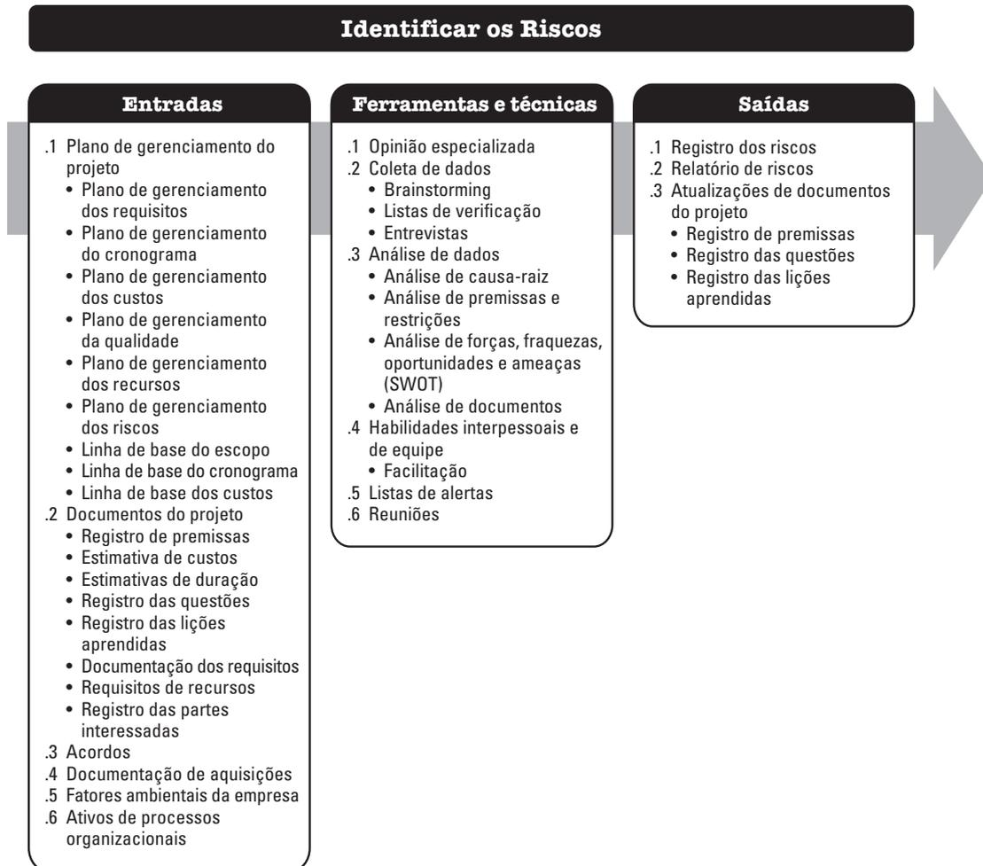
Figura 11-6. Identificar os Riscos: Entradas, Ferramentas e Técnicas e Saídas
